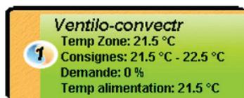
Figure 4 - Icône typique du régulateur de ventilo-convecteur
