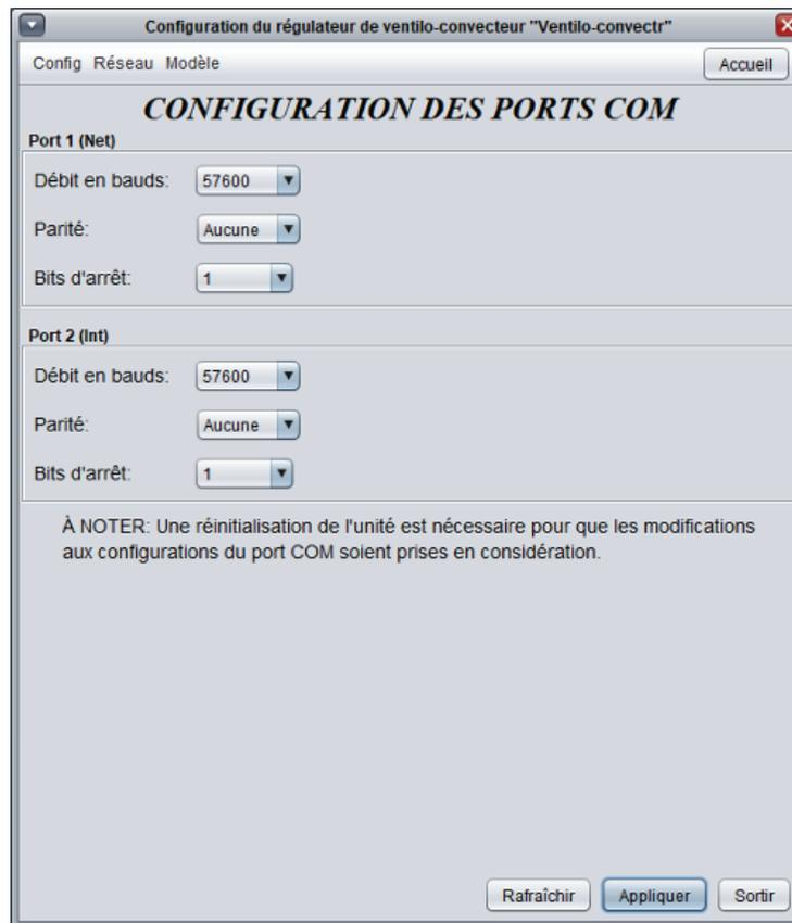
Figure 54 - Fenêtre de configuration des COM Port
