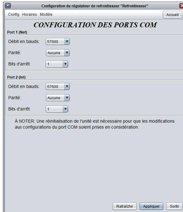
Figure 38 - Fenêtre de configuration des ports COM
