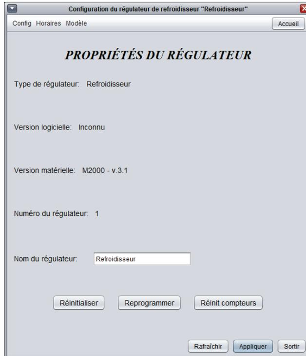
Figure 39 - Fenêtre des propriétés du régulateur
